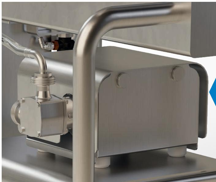
La **pompa autoadescante** in acciaio inox è adatta al trasferimento di fluidi di tipo alimentare. Si propone la migliore soluzione per travasare e svuotare completamente il pastorizzatore, senza alterare le caratteristiche organolettiche del prodotto. Attraverso il display si può modificare la velocità, adattandola così al tipo di densità e alle esigenze di riempimento dell'operatore.
