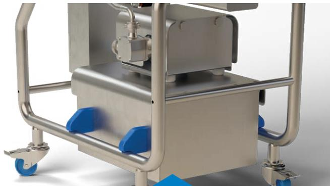
**Cabinet integrato.** Il compressore e la pompa sono alloggiati in due cabinet separati nella parte inferiore semplificando la movimentazione all'interno del laboratorio.
