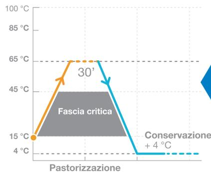
Con il sistema automatico di **autopastorizzazione (standard per 241 SP)** si può scegliere quando lavare la macchina fino ad un intervallo massimo di 42 giorni. Come ulteriore garanzia di sicurezza igienica, se l'operatore non esegue la pulizia integrale al termine dei giorni impostati, la macchina va in automatico in blocco.
