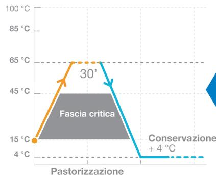
Con il sistema automatico di **autopastorizzazione (optional solo per XVL 1 e XVL 3)** si può scegliere quando lavare la macchina fino ad un intervallo massimo di 42 giorni. Come ulteriore garanzia di sicurezza igienica, se l'operatore non esegue la pulizia integrale al termine dei giorni impostati, la macchina va in automatico in blocco.
