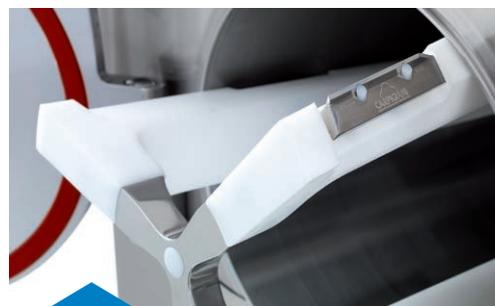
Agitatore in POM impenetrabile al freddo e al caldo, per la **completa espulsione del gelato e delle creme**; ha pattini raschianti auto-regolanti per la totale pulizia e resa del cilindro.
