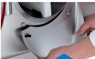
Lo scivolo di uscita dei prodotti è **smontabile**, per facilitare la completa rimozione di ogni residuo di gelato, creme o cioccolato, per una pulizia integrale.
